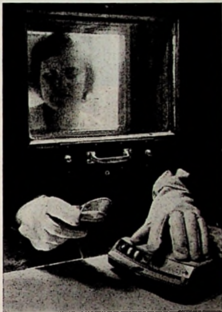
In deze klimaatkast beweegt de temperatuur zich tussen -75^{\circ}\text{C} en het kookpunt, waarbij dicteerapparaten op weersinvloeden worden beproefd. (Telefunken foto)
